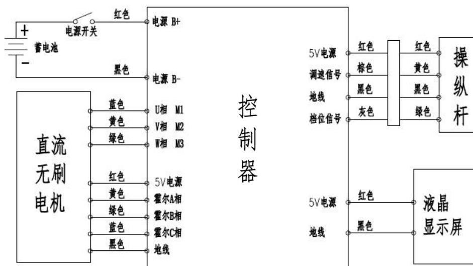
液晶显示屏显示内容：电源电压、工作电流、电机转速、故障指示等
